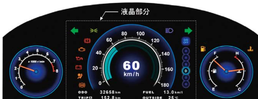
図5 高コントラスト液晶によるインパネのデザイン案 (夜間でも液晶の「黒」がキャビネットの「黒」に同化)
