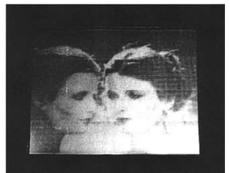
図7 シャープで最初に試作した単純マトリックス型液晶テレビの表示画像(1978年)
