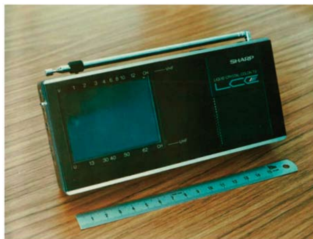
図19 A190P.T.の開発成果の小型カラー液晶テレビセットの試作品(図18はこの試作品の画面を撮影したもの)。この試作品によりa-Si TFT-LCDの事業化が決定され、事業化緊急開発プロジェクトA208P.T.が発足
