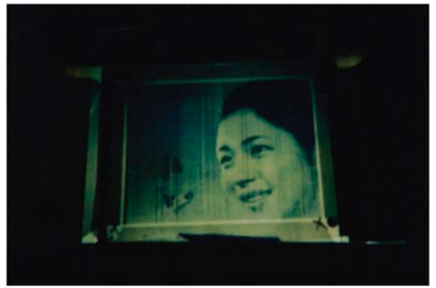
図15 独自テーマとして試作した階調付き白黒表示の3型a-Si TFT-LCD(248×204ドット)(1983年6月)
