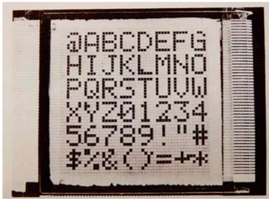
図13 通産省の補助金(初年度1982)を受けて試作したTe-TFTを用いた50×50ドットのマトリクス型LCD
