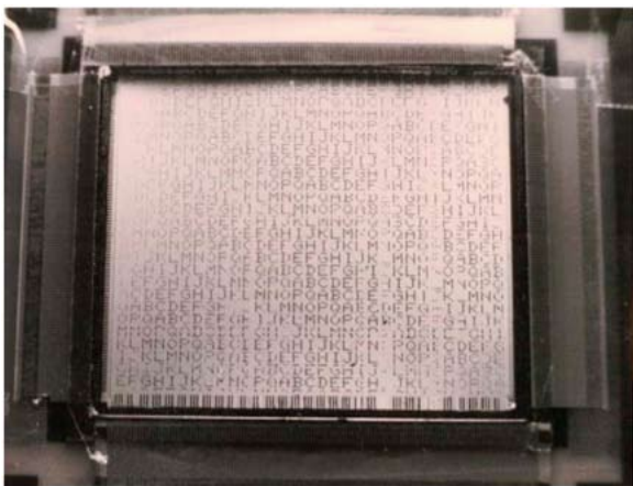
図14 通産省の補助金(次年度1983)を受けて試作したTe-TFTを用いた文字放送対応の3.2型248×204ドットのマトリクス型LCD
