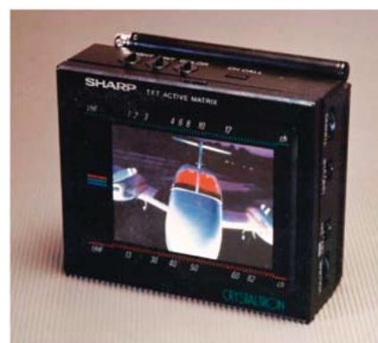
図20 事業化プロジェクトA208P.T.で開発された小型カラー液晶テレビ用の3型384X240(デルタ配列)a-Si TFT-LCD。1986年の9月に完成し10月のエレクトロニクスショーに出展し好評を得た。商品化は1987年5月から開始
