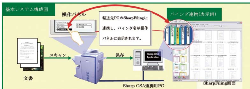
図3 「SharpFiling」とのシステム連携図
