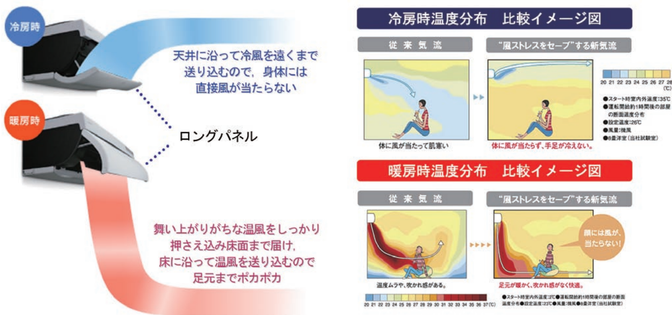
図5 上下両開きロングパネル気流制御技術を用いたエアコンの概略
