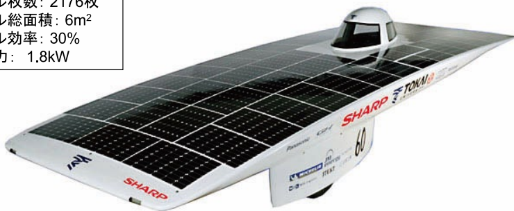
図3 宇宙用太陽電池 (>1.8kW) を搭載した東海大学ソーラーカー (グローバルグリーンチャレンジ2010で優勝)
