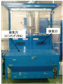
図5 蛍光管回収作業台
