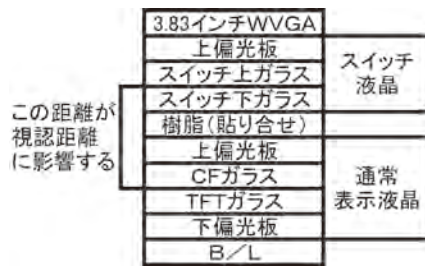
図3 3D液晶の厚み構造
