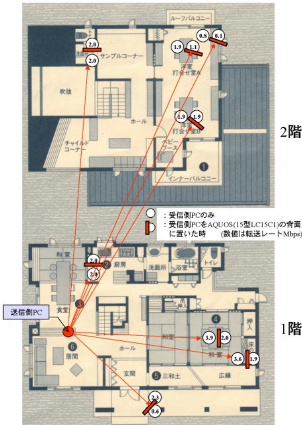
図3 無線LANを使った時のデータ転送レートの一例 Fig. 3 Example of data transmission rate using wireless LAN.
