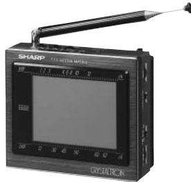
写真7 TV用フルカラー表示ノーマリーホワイト適用3型 a-Si TFT-LCD
