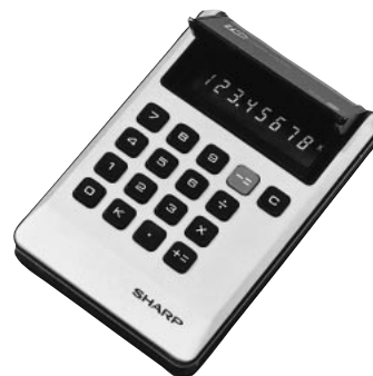
写真1 ポータブル電卓EL805 Photo 1 The first portable LC calculator EL805.
