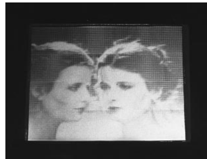
写真4 5.5型160×120ドットB/W液晶テレビ Photo 4 A 5.5" B/W LC-TV with a XY matrix LCD (160×120 dots).
