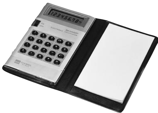
写真2 ポータブル電卓 EL8020 Photo 2 A portable calculator with a TN-LCD EL8020.
