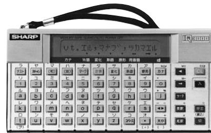
写真3 1行の英文字、カタカナ表示の電訳機 Photo 3 An electronic translator with an alphanumeric LCD.
