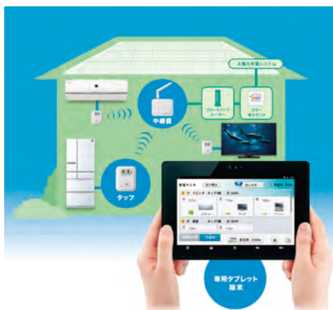
図 14 電力の見える化システム
