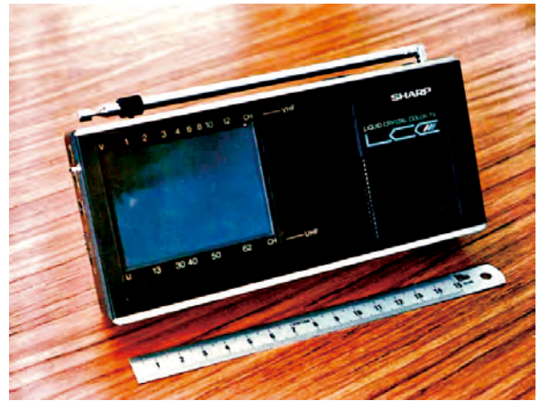
A109プロジェクトチームの開発成果である 3.2型カラーTFT液晶テレビ試作品(1985年10月)
