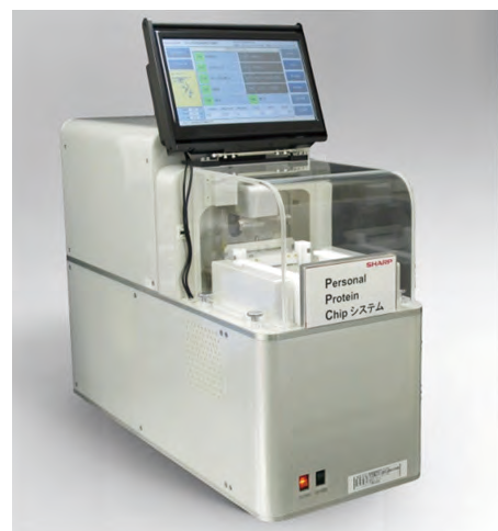
図2 全自動電気泳動・ブロッティング試作装置 Fig. 2 Prototype of fully automated tow-dimensional gel electrophoresis blotting device
