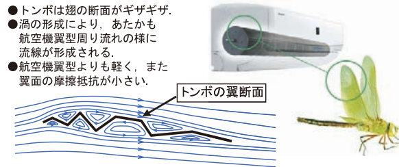
図5 トンボの翅の断面形とその周り流れ
