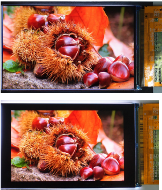
図10 超高精細プロトタイプパネルの写真 (a) 4.8型(b)4.1型 Fig. 10 Photo image of the prototype LCD panels.
