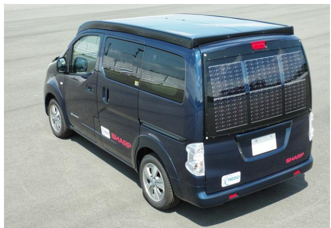
図2 1kW超の太陽電池パネルを搭載した電気自動車「e-NV200」
