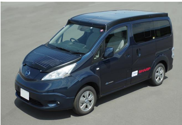
図1 複数の太陽電池セルにより構成された太陽電池パネル (左からルーフ、フード、バックドア)
