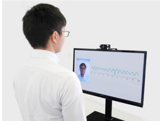
カメラによる脈波検出のイメージ（非接触バイタルセンシング技術）
