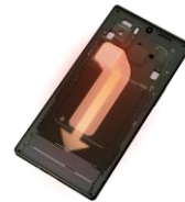
ベイパーチャンバーが下方向に内部の熱を拡散させるイメージ
