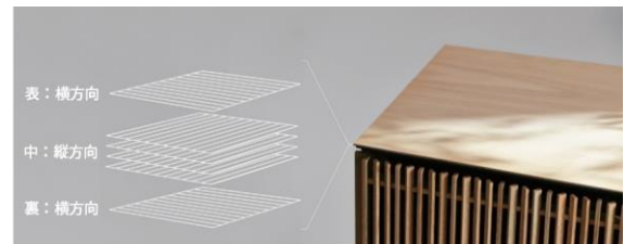
＜厚さ0.6mmの突板を6枚重ねて強度を確保＞
