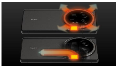
カメラリング（上）・ベイパーチャンバー（下）による放熱（イメージ）
