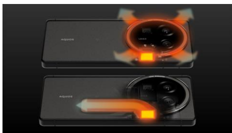
カメラリング (上)・ベーパーチャンバー (下) による放熱 (イメージ)
