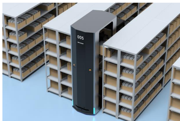
移載アームが商品保管棚から荷物をピックアップし、 収納棚へ格納
