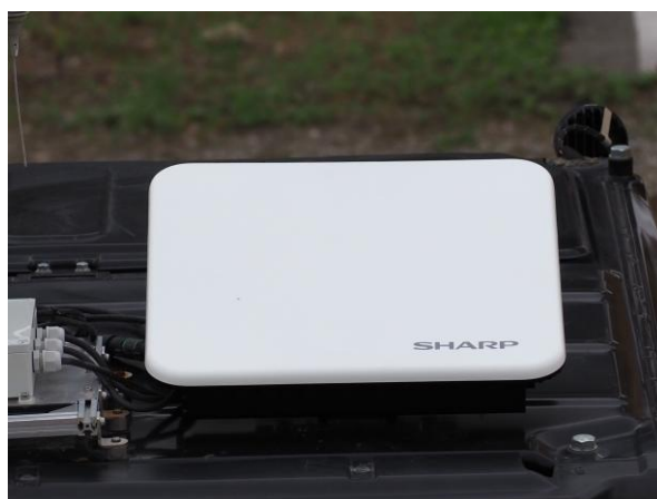
左：衛星通信ユーザー端末を上部に設置した建設機械、右：建設機械上部に設置された衛星通信ユーザー端末
