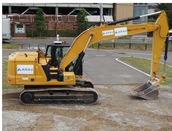
左：衛星通信ユーザー端末を上部に設置した建設機械、右：建設機械上部に設置された衛星通信ユーザー端末
