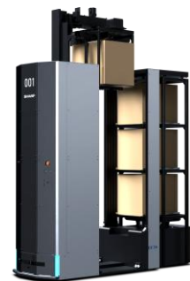
スリムスタッカー・ ロボットストレージシステム 搬送ロボット（カスタム機）
