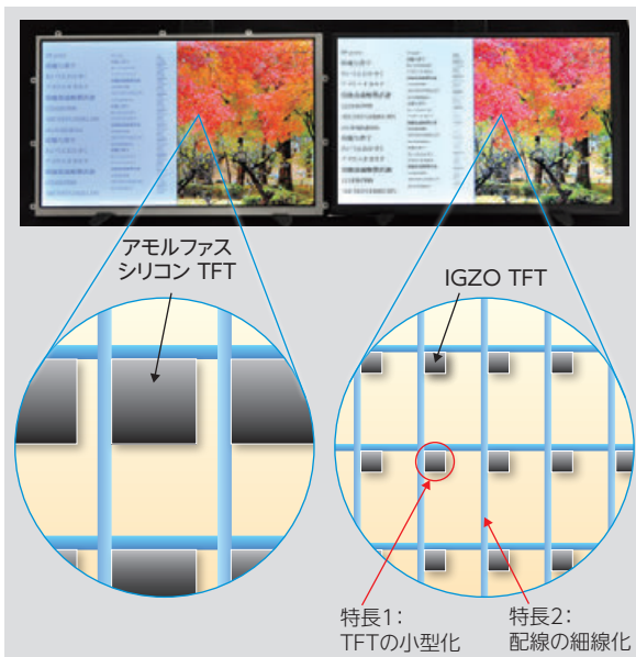
比較展示と画素のイメージ 従来の液晶(左)とIGZO液晶(右)
