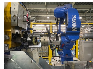
アーム型多軸ロボットの導入で工程を自動化
