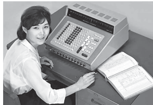
世界初のオールトランジスタ電子式卓上計算機「コンペット」<CS-10A>
