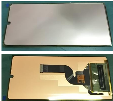
超高輝度OLEDモジュール (上：表示部、下：回路基板部)
